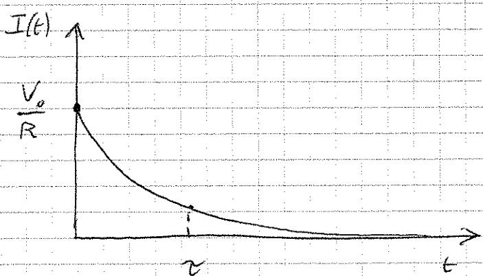
Per  $t \gg \tau$  il condensatore è carico e  $V_c = V_0$ .
