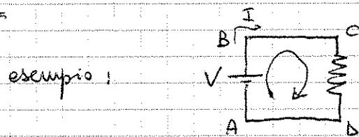
$$V - IR = 0 \quad \begin{array}{l} \rightarrow \text{cedute di potenziale} \\ \text{aumento di potenziale} \end{array}$$
